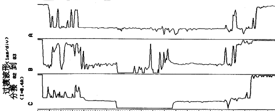
图A.9 双电阻V型分接开关触头接触不良直流试验波形
